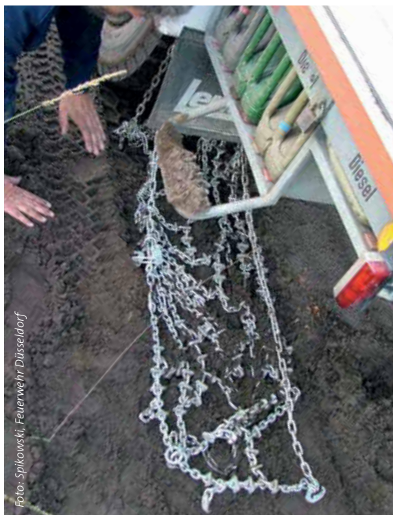
▲ Abb. 8: Stabile Gleitschutzketten können nicht nur auf Schnee, sondern auch in schwerem Gelände eine wertvolle Traktionshilfe sein. Ihre Anwendung muss geübt werden.
