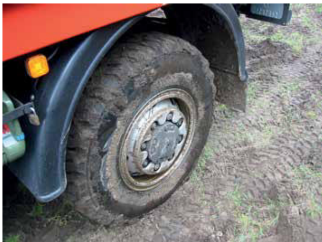
▲ Abb. 6: Geländereifen auf einem „richtigen“ Geländewagen werden für die Traktion im Gelände inklusive ihrer speziellen Eigenschaften (u.a. selbst reinigende Profile) benötigt.
