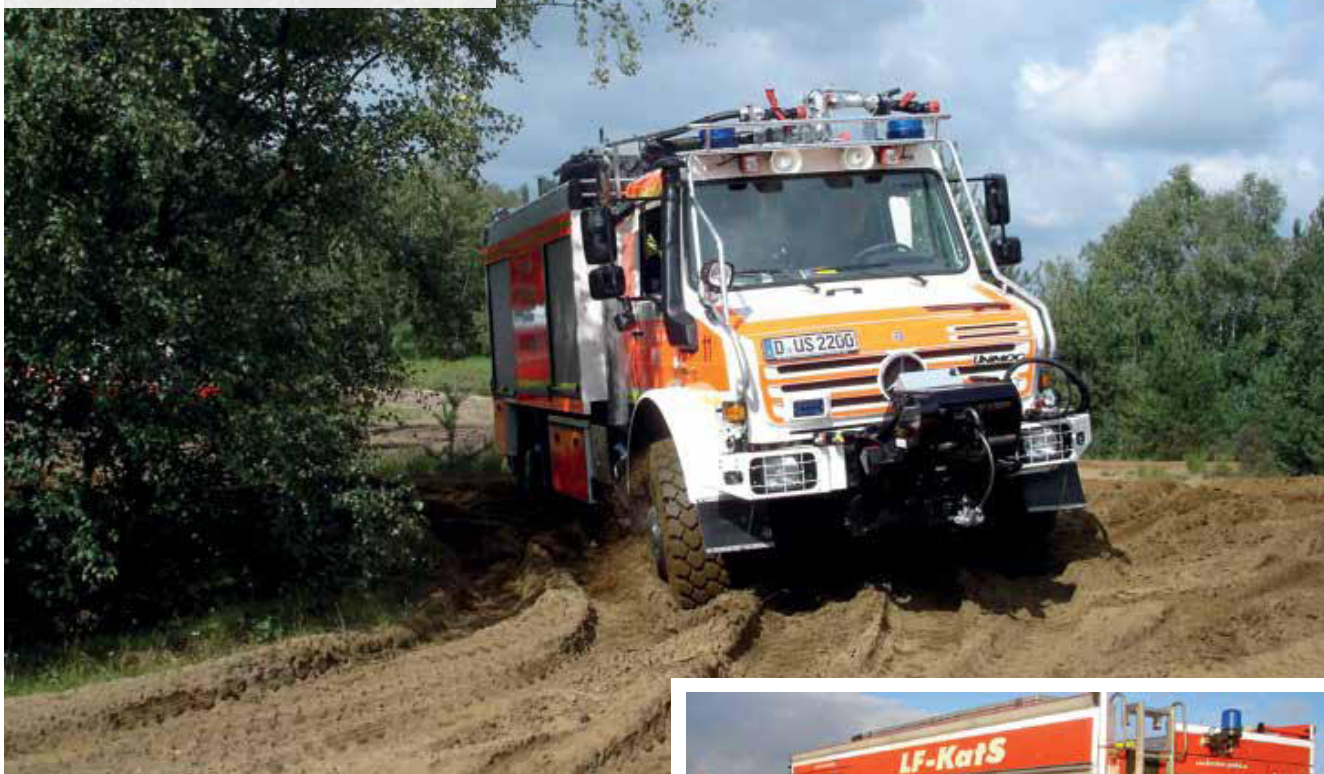
Abb. 3: Für geländegängige Fahrzeuge gibt es oft gar keine Winterreifen, sondern entsprechend ihrer baulichen Ausrichtung auf den Einsatzzweck grob profilierte Geländereifen. Diese Fahrzeuge dürfen trotzdem auch bei Schnee und Eis genutzt werden, wenn sie die oben beschriebenen Ausnahmen erfüllen.
