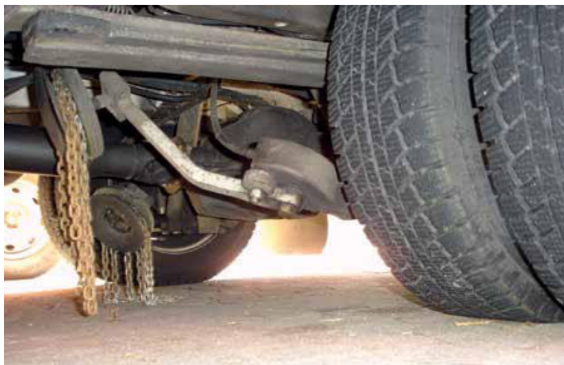
▲ Abb. 7: Schleuderketten hier an einem RTW.
