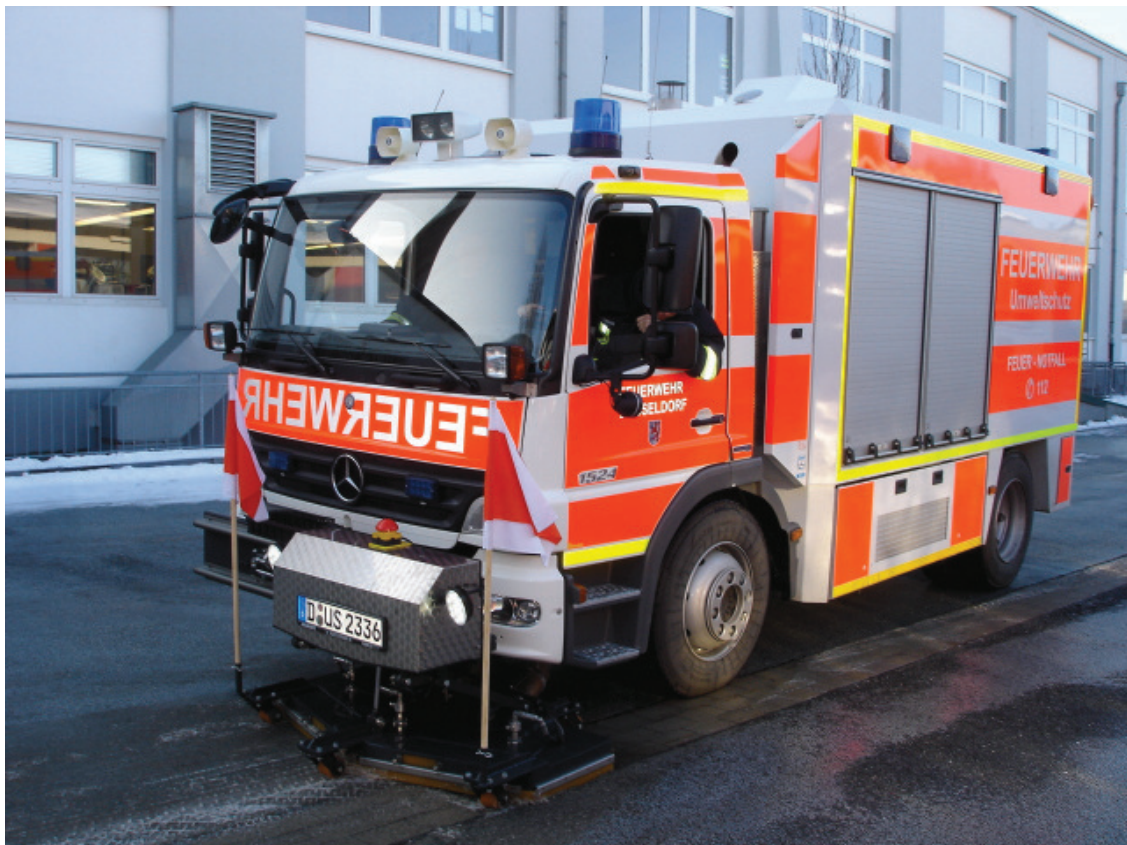
Abb. 3: Ein ÖWSF hat - ähnlich wie Kehrmaschinen - am Rahmen umfangreiche Aggregate verbaut. (Foto: Cimolino)
