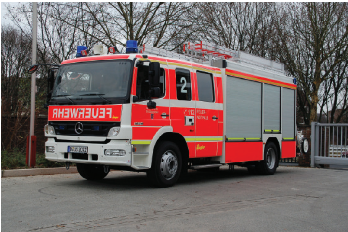
Abb. 1: Tiefgezogene Geräteräume und Gruppenkabinen können beim Aufbau auf Fahrgestelle mit Euro VI-Motoren zum Problem werden. (Foto: Cimolino)
