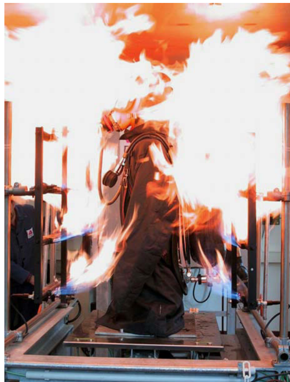
Bild: Prüfung der Beflammung (Foto: DEKRA EXAM GmbH)
